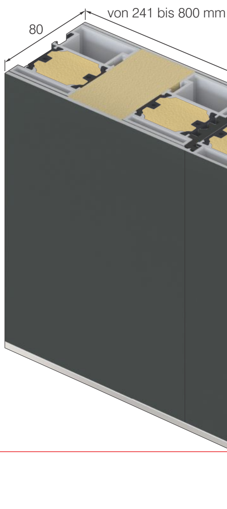
BEISPIEL AT 95 BLENDRAHMENVERBREITERUNG PLUS - mit Polyurethan gefüllte Profile
